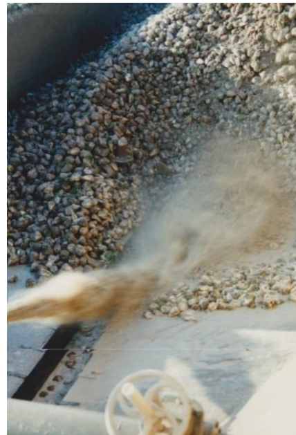
Le jet de la « mitrailleuse » pousse les betteraves.
