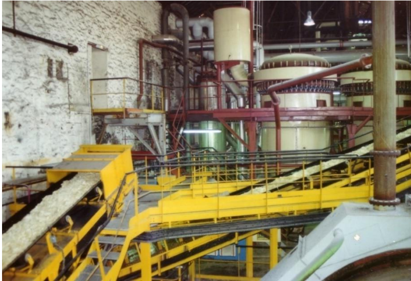
Les cossettes sont acheminées jusqu'à la diffusion (au fond : la 1ère filtration)
