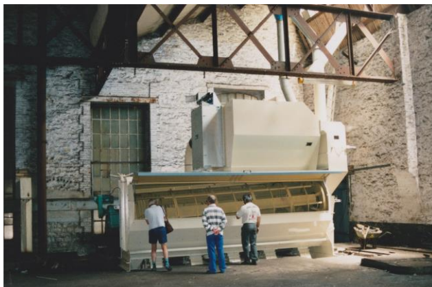
Un filtre neuf à refiltrer les boues retrouvé au moment de la démolition,
